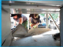
Entfernung des alten Kofferraumbodens
