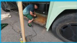
Entfernung der verrosteten Streben und leichter Rostschäden
