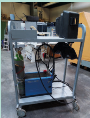
Umbau eines alten Medienwagens für unser Schweißgerät
